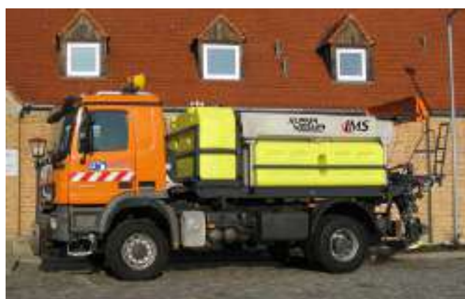
Épandeuse qui peut distribuer du sel préhumidifié ou de la saumure seule.
