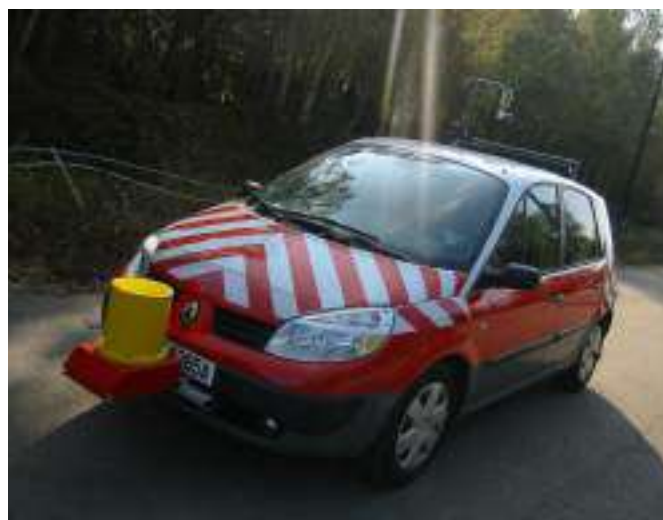
Vehículo para realización de perfil termohídrico
