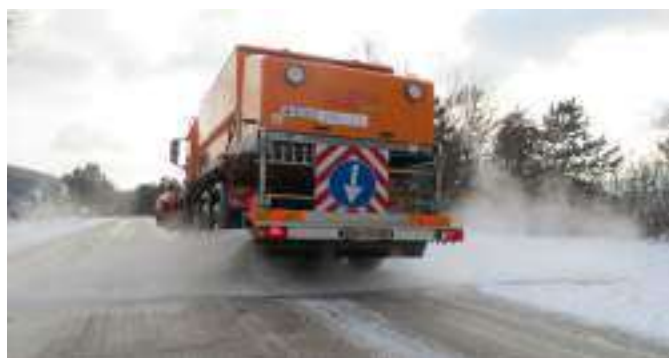
Figure 5 – Balai mécanique équipé pour l'épandage de saumure de chlorure de sodium
