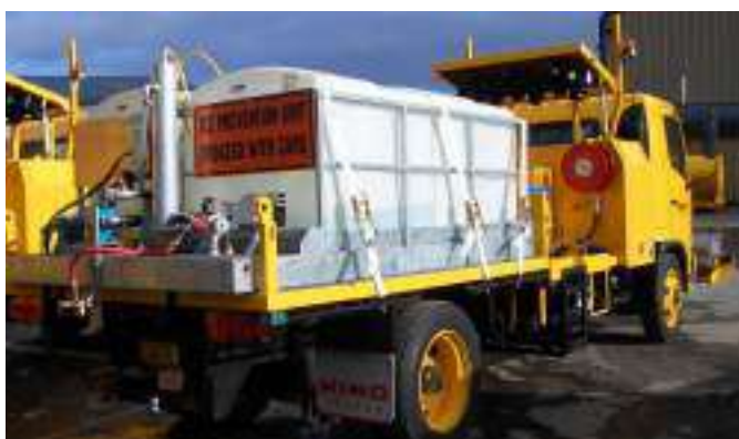
Esparcidor de ACM líquido
