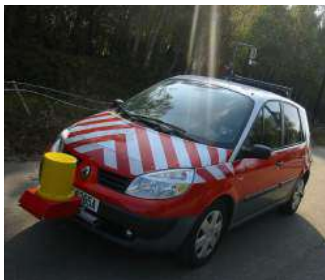
Véhicule pour le relevé thermohydrigue
