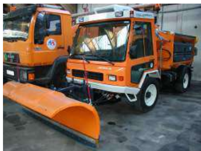
Figura 2 – Camión con pala quitanieves y equipamiento F 30 para uso urbano o carretera
