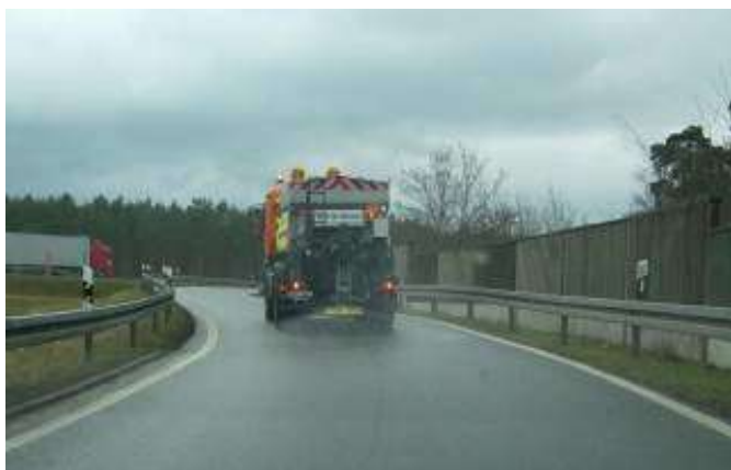
Épandeuse qui peut distribuer du sel préhumidifié ou de la saumure seule.
